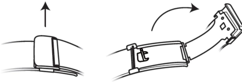
2. Ziehen Sie die untere Platte nach oben, so dass sie sich in einem 90°-Winkel zum Armband befinden.
