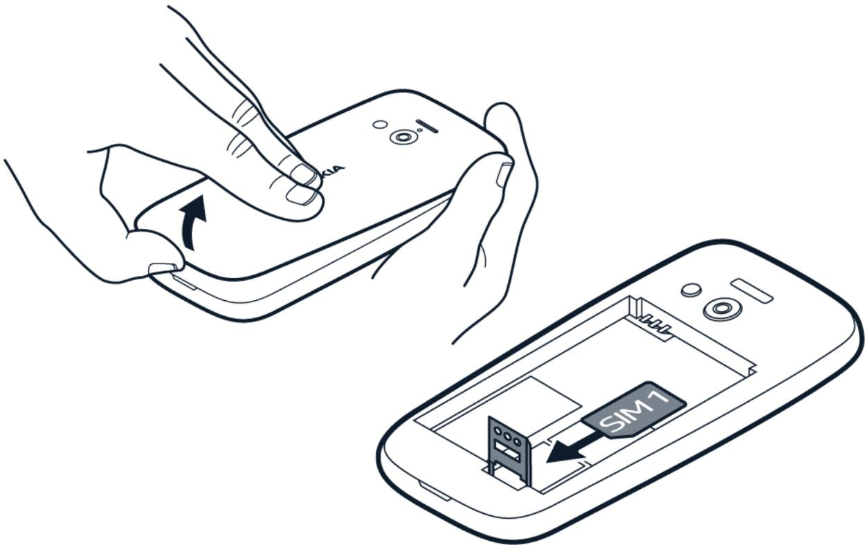
1. Führen Sie Ihren Fingernagel in den kleinen Schlitz auf der Unterseite des Telefons ein und entfernen Sie die Abdeckung.
