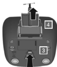
Ak chcete odpojiť konektor z nabíjacej kolíske, stlačte uvoľňovacie tlačidlo **3** a odpojte konektor **4**.
