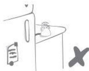
Ujistěte se, že HUB není umístěn na velkých kovových předmětech.
