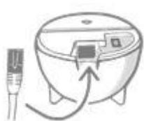
Namontujte napájecí zdroj a zapojte jej do elektrické zásuvky. Druhý konec kabelu zapojte do základny HUB.
