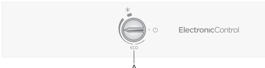
A Hőfok beállítására, a készülék be/kikapcsolására és a gyorsfagyasztás funkció aktiválására szolgáló gomb
