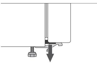
Az ajtó sarkain távtartók találhatók. Távolítsa el ezeket és a résekbe helyezze be a mellékelt dugókat (csak egyes modellekknél).
