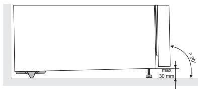
A készülék elhelyezéséhez legalább két személyre van szükség, a sérülések és a készülék károsodásának elkerülése érdekében.
