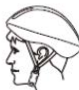
Nesprávně Čelo není zakryto
