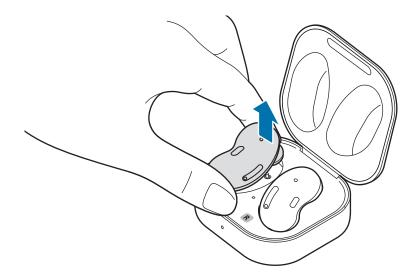
Prüfen Sie die Ausrichtung der Ohrhörer und richten Sie sie so aus, dass die untere Hälfte (Lautsprecher) zum unteren Ende Ihrer Ohren zeigt.
