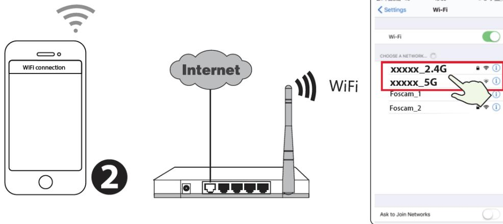
*Tip:* Die Kamera unterstützt 2,4-GHz- und 5-GHz-Dualband-WLAN-Netzwerke, sodass Sie den Kanal mit dem stärkeren Signal auswählen können, das Sie verwenden möchten. Wählen Sie beispielsweise Ihre SSID aus: XXXXX\_2.4G oder XXXXX\_5G.
