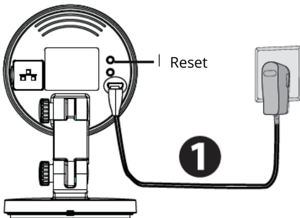
*Tipps:* Wenn Sie keine Sprachaufforderung gehört haben, setzen Sie die Kamera zurück, indem Sie die Reset-Taste etwa 10 Sekunden lang gedrückt halten.
