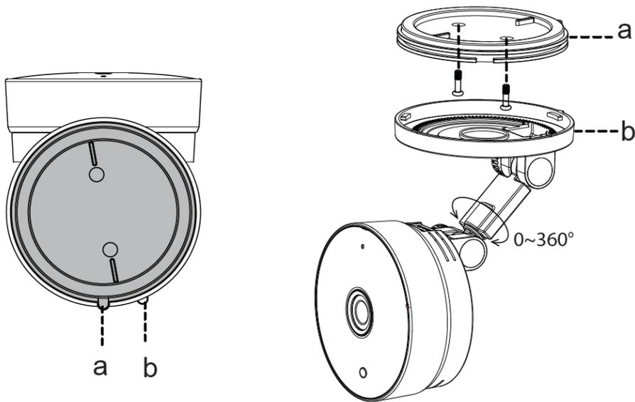
1. Drehen Sie die Kamerabasis, bis die Punkte A und B ausgerichtet sind, damit die Montageplatte entfernt werden kann.
