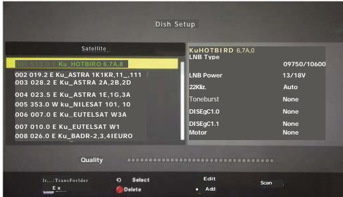
Wenn ein Parameter falsch ist oder Ihre Antennenanlage keine Auto oder Nic/None Werte akzeptiert, wird dieser Satellit nicht empfangen oder ein anderer Satellit wird unter dem Namen des bestimmten Satelliten empfangen.
