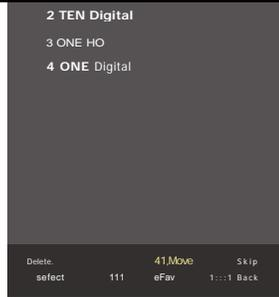
Zur Programmierung des Kanals gibt es drei farbige Tasten Drücken Sie zunächst die Tasten **V/A**, um den gewünschten Kanal auszuwählen. Dann: Mit der **roten** Taste entfernen Sie das Programm aus der Liste. Verwenden Sie die **gelbe** Taste, um das Programm zu verschieben. Verwenden Sie die **blaue** Taste, um den ausgewählten Kanal zu überspringen (das Fernsehgerät überspringt den Kanal automatisch, wenn Sie die Tasten **PR+/-** zum Wechseln der Kanäle verwenden).
