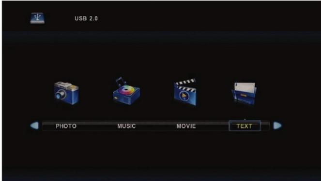
Wählen Sie mit den Tasten **■|▶** das Laufwerk aus, in dem Sie anschauen möchten, und rufen Sie dann mit der Taste **OK** die Schnittstelle auf.
