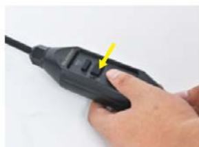
2. Nyomja meg a "RESET" gombot, a jelzőfény pirosra vált.
