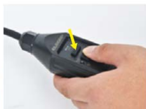
3. Nyomja meg a "TEST" gombot, a jelzőfény kialszik.
