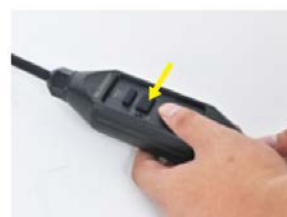
4. Stiskněte tlačítko "RESET", kontrolka se rozsvítí červeně. Přístroj RCD funguje správně.
