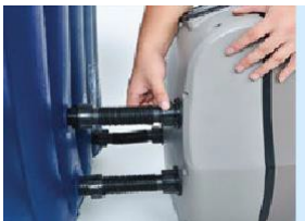
8) Csatlakoztassa a szivattyúegységet a pezsgőfürdőhöz a 3 csavaros csatlakozó segítségével. Ellenőrizze, hogy a szivattyún és a kádon lévő jelölések meg egyeznek-e.
