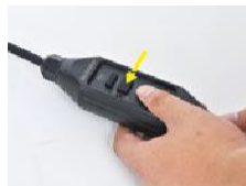
4. Nyomja meg a RESET gombot, a kijelző pirosan világít. Az RCD megfelelően működik.
