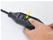
2. Nyomja meg a RESET gombot, a kijelző pirosan világít.
