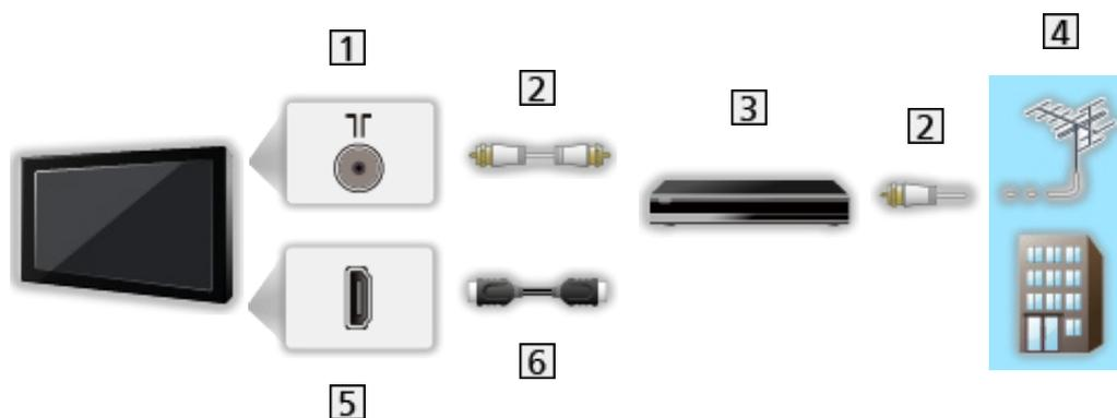
1 Anschluss für terrestrische Antenne / Kabel
