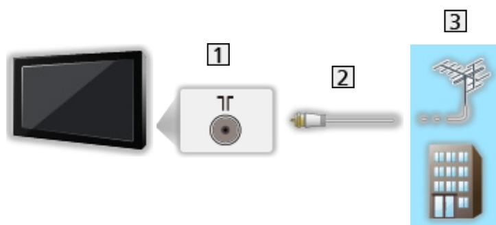
1 Anschluss für terrestrische Antenne / Kabel
