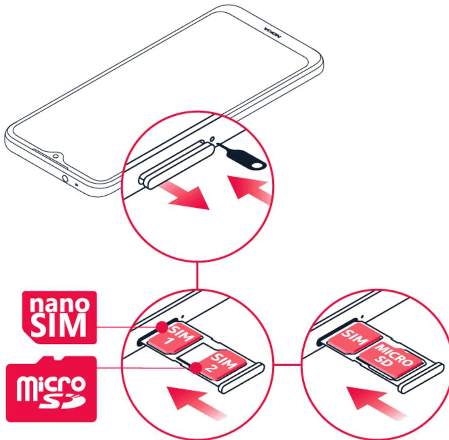
1. Öffnen Sie das SIM-Kartenfach: Setzen Sie den Öffnerstift in die Vertiefung des Fachs, und ziehen Sie das Fach heraus.
