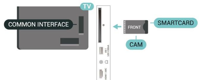
Wenn Sie den Fernseher einschalten, kann es möglicherweise etwas dauern, bis das CA-Modul aktiviert wird. Wenn ein CAM eingesetzt und das Abonnement bezahlt wurde, (wobei sich die Verbindungsmethoden unterscheiden können), können Sie die von der CAM Smart Card unterstützten verschlüsselten Sender ansehen.
