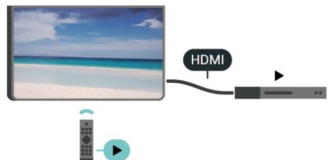
Dazu muss HDMI CEC (Consumer Electronic Control) auf dem Fernseher und dem angeschlossenen Gerät eingeschaltet sein.
