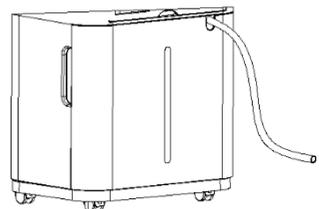
damit das Kondensat frei abfließen kann. Der Ablaufschlauch muss vom Auslauf nach unten ausgerichtet sein, siehe Abbildung.
